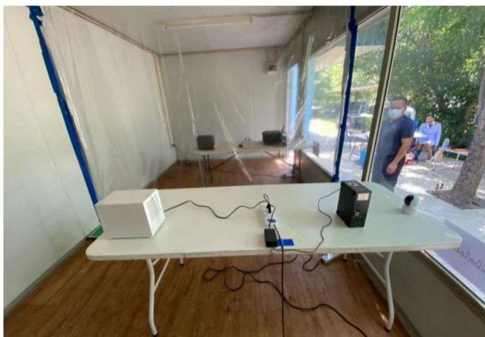
รูปแสดงการแบ่งห้องทดสอบออกเป็น ๒ ห้อง และการติดตั้งอุปกรณ์ในการทดสอบ
